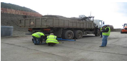
Execução de ensaios de placa no terreno natural
